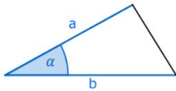
Sind in einem beliebigem Dreieck  $ABC$  zwei Seiten  $a$  und  $b$  und der Winkel  $\alpha$ , der von beiden Seiten eingeschlossen wird, bekannt, so gilt für den Flächeninhalt  $A$  des Dreiecks:
